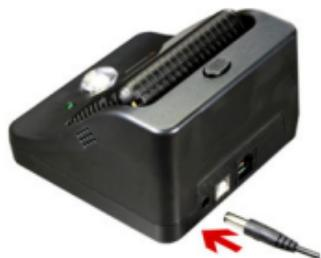
2) DC-Stecker des Steckernetzteils in die Buchse des Ladegerätes einstecken. Die grüne Lampe leuchtet.
